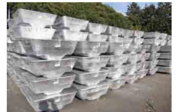
Can to Can製品「アルミ缶再生塊」
