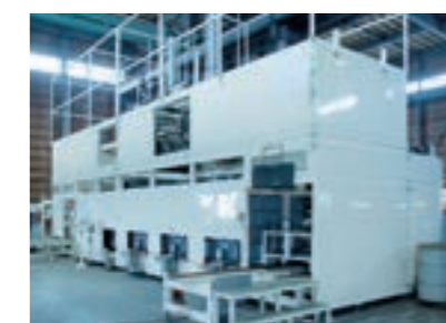
細かく砕いたチタンスクラップの脱脂、水洗い、乾燥を行う洗浄機（昭和メタル㈱直江津事業所）。
