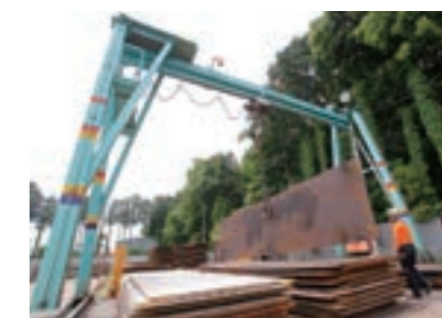
阪和エコスチール㈱の敷鉄板は、災害地の道路復旧作業時の足場などにもレンタルされるなど、様々な現場で活躍しています。
