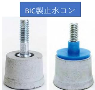
現場でコンクリートを打設する場合、型枠（コンパネ）保持部材が必要ですが、型枠解体後に保持部材の跡をモルタル等で埋め戻す膨大な作業が発生します。その作業をワンタッチで解決できるのが、止水コン、P コン穴埋め栓です。
